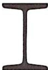
Figura 10 – Seção típica de um perfil laminado de aço. Fonte: Beckmann; Bowles, 2004, p. 202.
