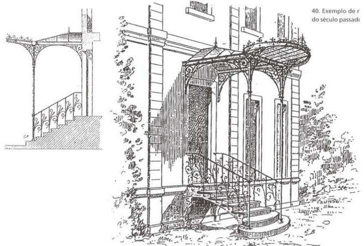
Figura 62 - Exemplo de marquise metálica. Desenho retirado de tratado do final do século XIX. Fonte: Kühl, 1998.
