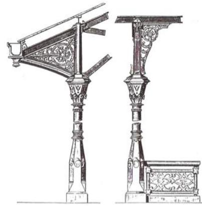
Figura 73 - Detalhe de coluna, mão francesa e balaustrada em ferro fundido ricamente ornamentadas. Fonte: Kühl, 1998. p. 86.
