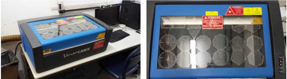
Figura 17: Processo de corte das bases dos Sólidos Dinâmicos
