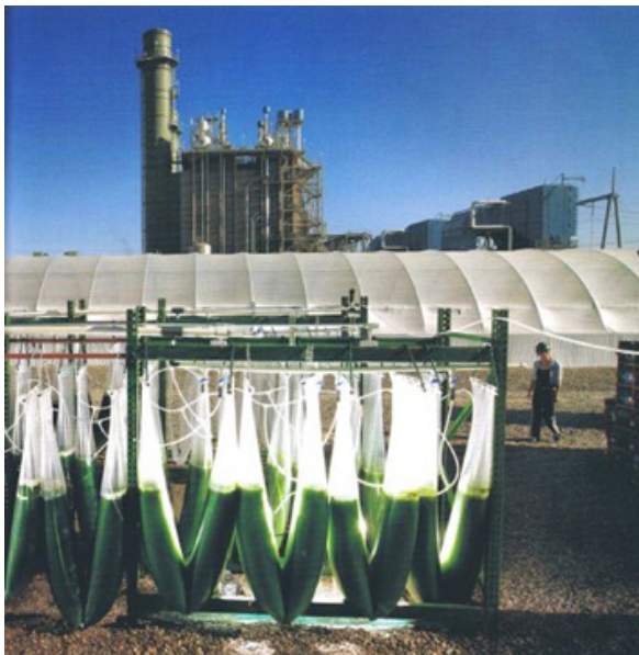
Figura 17. Fotobiorreatores de mangas no exterior da central elétrica de Redhawk, perto de Phoenix (EUA), propriedade da GreenFuel. Fonte: BOURNE Jr, J.K., 2007
