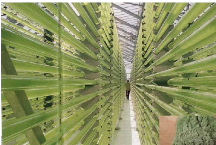
Figura 20. Fotobiorreator tubular horizontal. Fonte: BERG-NILSEN, J. (2006)
