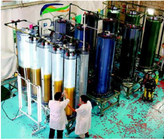
Figura 15. Fotobiorreator vertical da Universidade de Alicante, Espanha. Fonte: Universidade de Alicante (2007)
