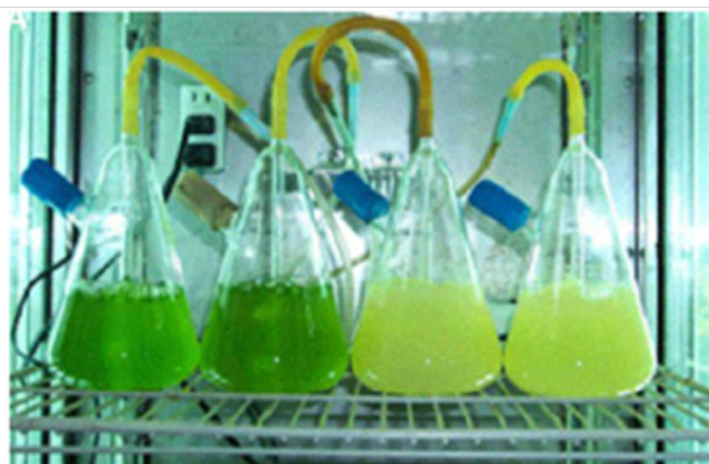
Figura 11. Obtenção de microalgas em fotobiorreatores em escala de bancada. Fonte: Xu et al. (2006).
