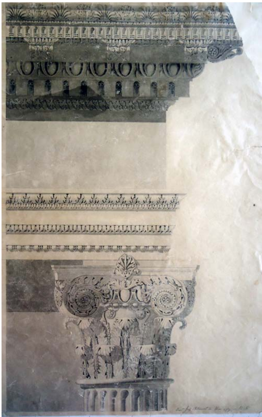
Figura 2 - Desenho de Bethencourt da Silva, datado de 1845. Desenho de um entablamento e capitel Compósito. Acervo Museu D. João VI - EBA -UFRJ, nº registro 934
