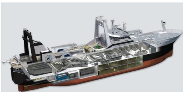
**Figura 55:** Desenho esquemático do interior de um navio fábrica, mostrando vários compartimentos de processamento da pesca.
