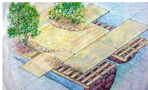
**Figura 10:** Desenho explicativo sobre o sistema construtivo da ilha.
