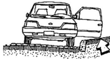
Esquema 1 - Uma sarjeta muito larga ou uma guia muito alta farão com que as portas dos automóveis batam nelas ao se abrirem. Sarjeta estreita ou uma guia baixa diminuem a capacidade de escoamento superficial da rua.
