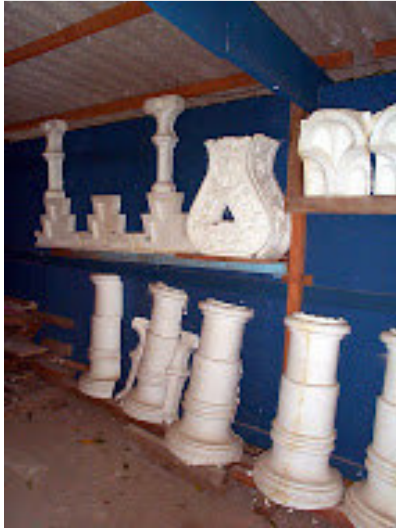
Figura 7: Oficina de trabalho em canteiro de obras. Confeção de formas e ornatos. Fiocruz, 2011?
