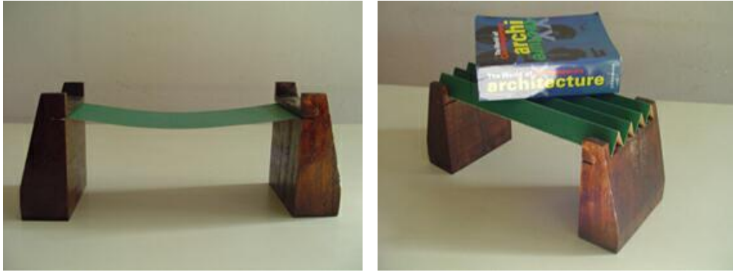
Figura 54. Modelo de demonstração da Rigidez obtida pela modificação da forma FONTE: http://www.fau.ufrj.br/apostilas/mse/PlacasAs.htm Acesso em 03.01.2016
