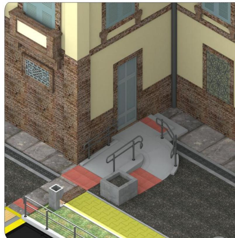
As rampas projetadas são em concreto, com sinalização tátil nos patamares e corrimãos em aço inoxidável. Deverão ser apoiadas parcialmente sobre os passeios em laje de pedra, com o cuidado de não comprometer a preservação dessas cantarias.
