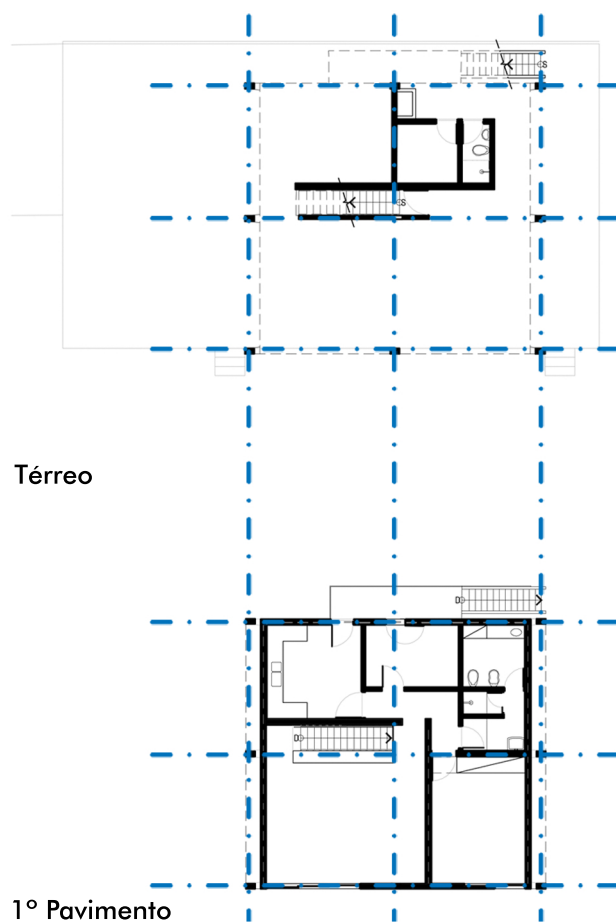
Fig. 99 Esquema da malha estrutural da Residência de Fim de Semana indicando o eixo dos pilares nos dois pavimentos. Sem escala. Fonte: Desenho da autora, 2016.
