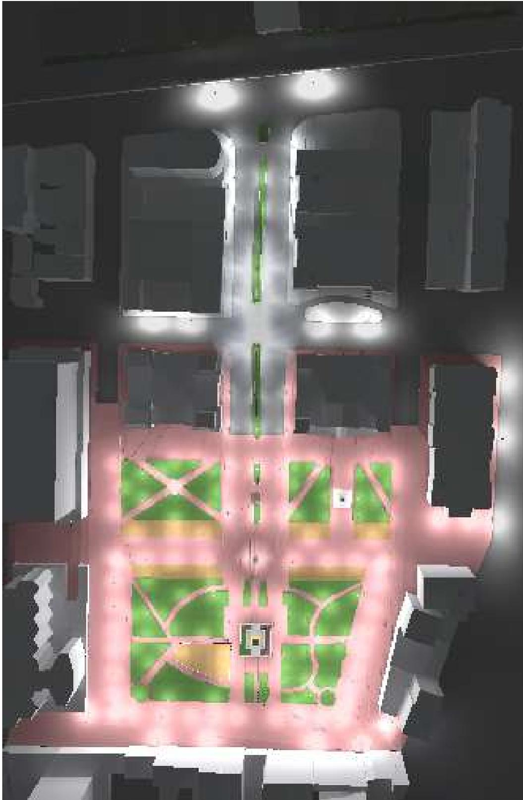
Figura 89- Efeito da iluminação funcional calculado pelo software Dialux (a temperatura de cor não é representada, apenas a quantidade de luz). Fonte: figura produzida pela autora, 2016.
