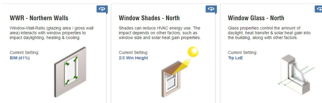
Figura 53 : Recorte de alguns quadros de parâmetros analisados simultaneamente pela plataforma Insight 360. Para uma determinada orientação, são analisados: as dimensões da abertura, os tipos de sombreamento da abertura e os tipos de vidro da esquadria. Fonte: Insight 360 / Autodesk.
