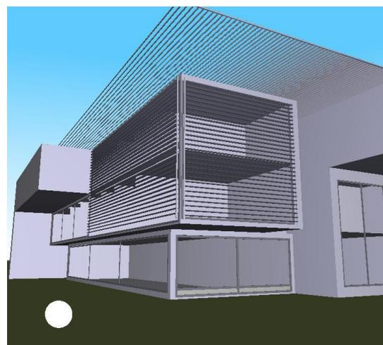
Figura 76 : Ponto de vista do pedestre na esquina. Brise horizontal, aleta a  $0^\circ$ .
