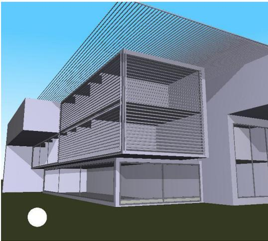
Figura 77 : Ponto de vista do pedestre na esquina. Brise horizontal, aleta a 30°.
