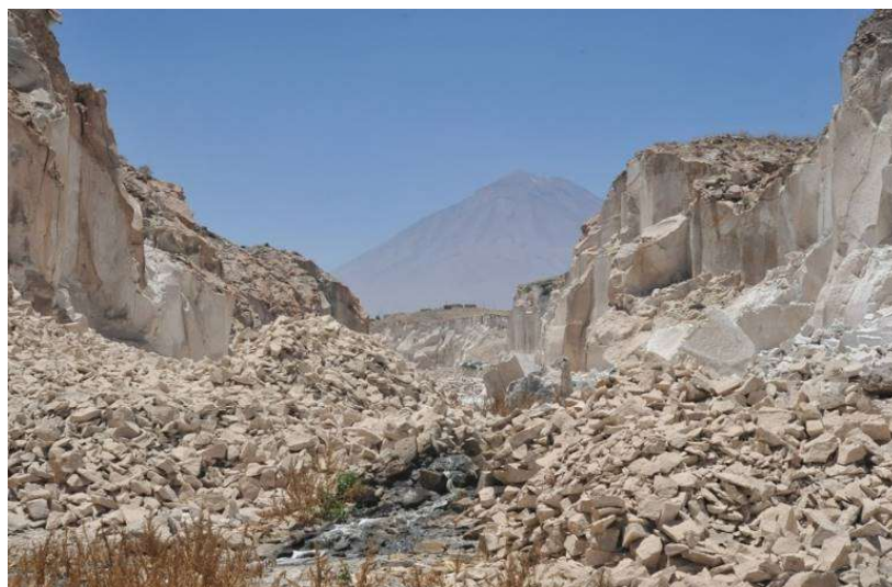
Figura 111: Desperdício de sillar e contaminação de águas industriais em Añashuayco. Fonte: nexmidaza.blogspot.com.br. Acesso em 20/05/2016.
