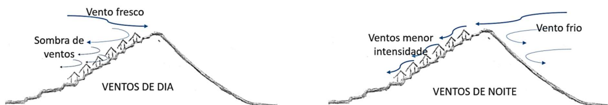
Figura 99: esquema de ventilação dos períodos diurno e noturno no complexo de Churajón. Fonte: elaboração do autor
