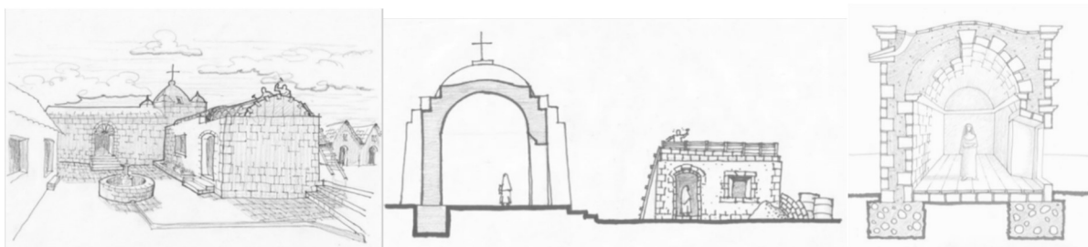
Figura 78: imagens do sistema estrutural de muro duplo de sillar e tetos abobadados. Fonte: Rioz (2014)
