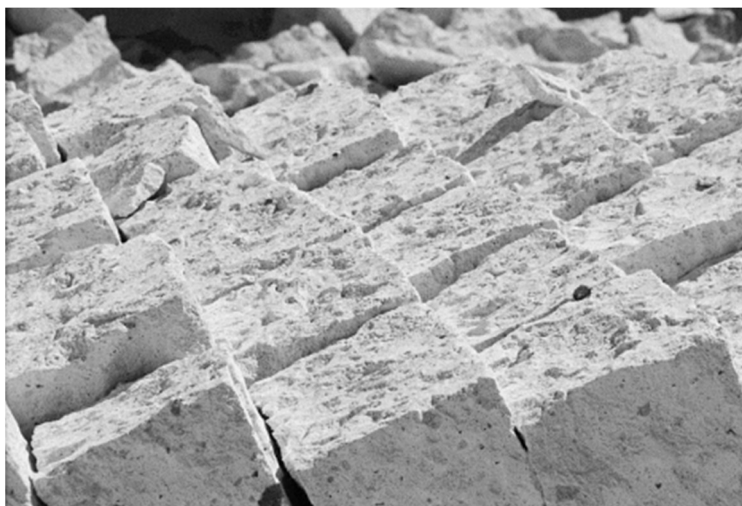
Figura 112: bloco de sillar 200 x 300 x 550mm. Fonte: UNSA Arequipa,
