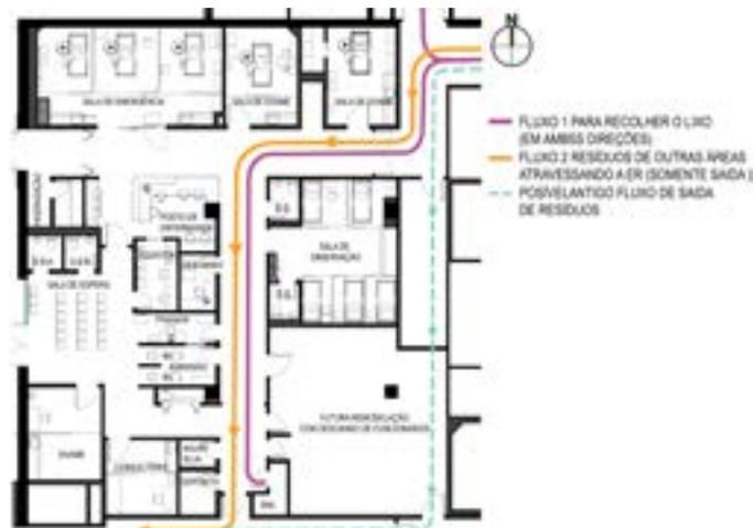
Figura 97. Planta arquitetônica com o fluxo de resíduos.
