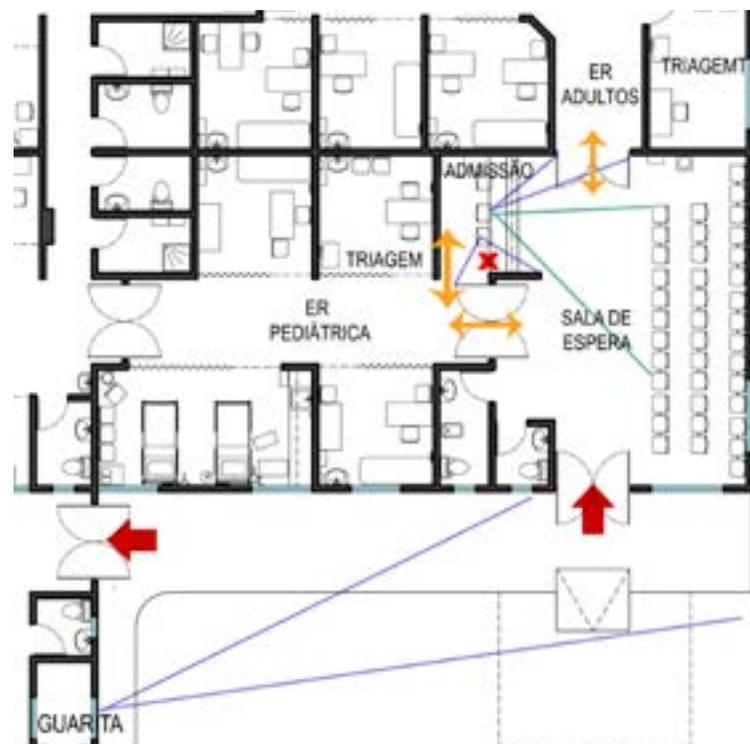
Figura 96. Conexões entre os ambientes de chegada e as áreas de atendimento, mostrando os ângulos de visibilidade do acesso. Fonte: levantamento da autora.
