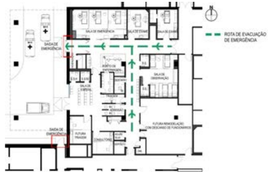
Figura 101. Planta arquitetônica com a Rota de Evacuação de Emergência do HMVP. Fonte: HMVP (Trabalhado pela autora)
