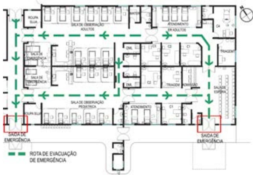
Figura 100. Planta arquitetônica com Rota de Evacuação de Emergência do Sermesa. Fonte: levantamento da autora
