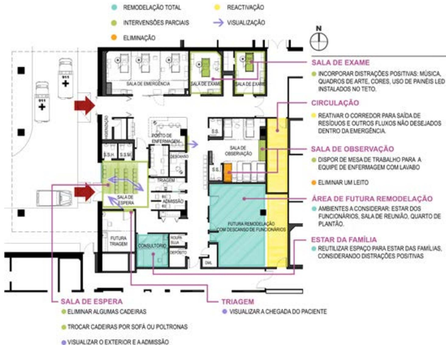
Figura 108. Planta esquemática com as mudanças sugeridas, HMVP. Fonte: autora.
