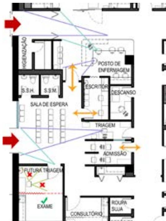
Figura 95. Conexões entre os ambientes de chegada e as áreas de atendimento, mostrando a relação da triagem com o acesso. Fonte: HMVP (trabalhado pela autora).
