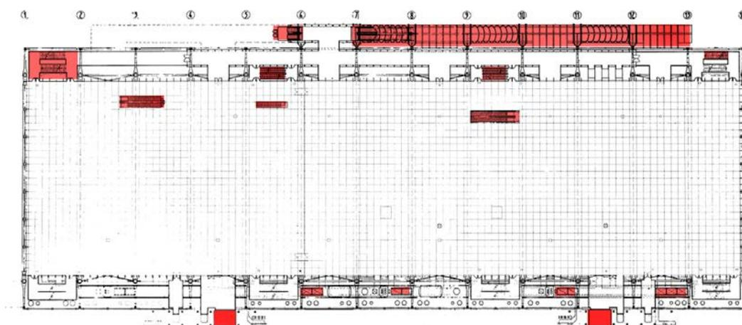
**Figura 1.28:** Planta baixa do Centro Pompidou. Em vermelho elementos de circulação vertical. Richard Rogers e Renzo Piano, 1969 Editado a partir de Fundação Renzo Piano.
