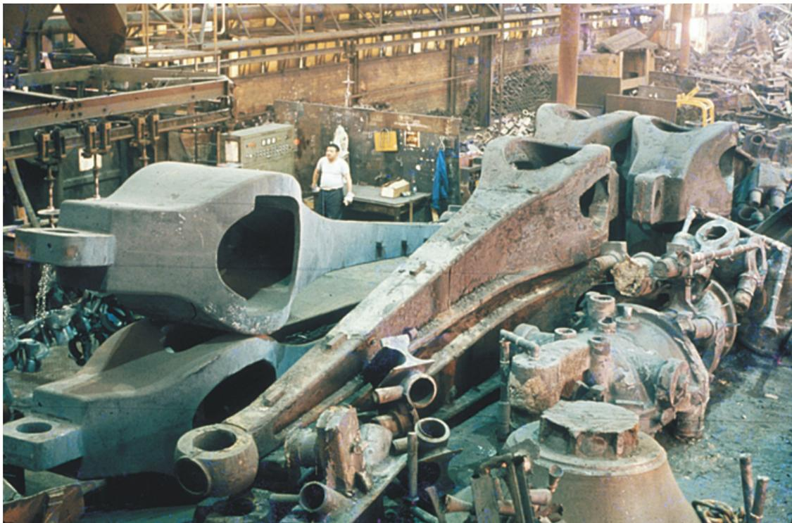
**Figura 4.22:** Fabricação das peças estruturais do tipo gerberetti, centro George Pompidou.. Fonte: Fundação Renzo Piano.
