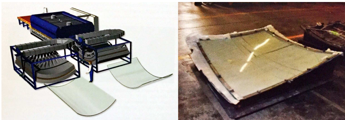
Figuras 27 / 28: processos industriais de fabricação de painéis de vidro curvos
