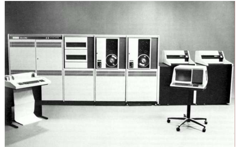
Figura 7: conjunto com uma CPU VAX11-780, computador mainframe lançado em 1977 pela DEC. fonte: http://electronic-engineering.ch/fpga/projects/dhrystone/VAX_11-780.gif
