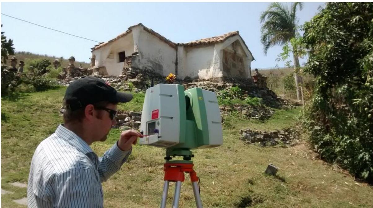
Figura 37: Equipamento sendo calibrado e nivelado para a primeira cena pelo técnico Kezio Arruda. Fonte: Acervo Ivo Barreto, 2016.
