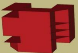
CRIAÇÃO DE UM CHAMFRÓ NA PARTE ESQUERDA DO TÉRREDO ONDE FICARÁ A ENTRADA DA BIBLIOTECA E SUBTRAÇÃO DE VOLUME NA PARTE DIREITA SOLTANDO O VOLUME DO CHÃO NA LATERAL
