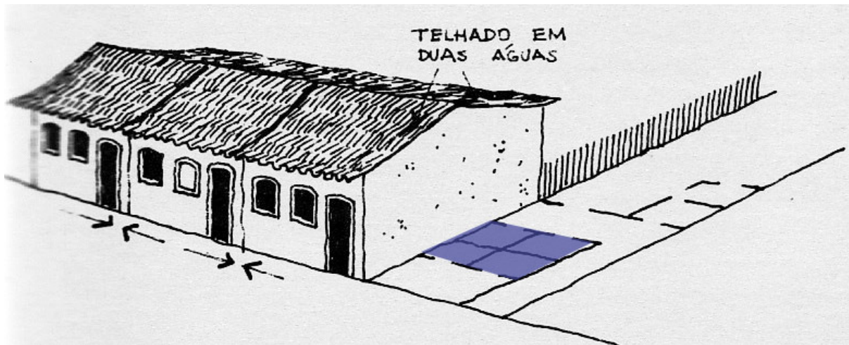
Figura 6 - Telhados em duas águas, lançando parte das águas sobre a rua, e parte no quintal. Os cômodos intermediários representados no esquema, em azul, não recebiam iluminação natural, pois não existiam aberturas no telhado para este fim. Fonte: REIS FILHO, 2006, p. 31. Intervenções realizadas pela autora.
