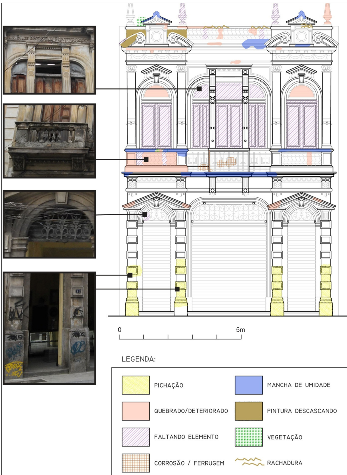
Fig. 58 - Mapeamento de danos da fachada. Fonte: Desenho da autora sobre base fornecida pelo Arquivo Geral da Cidade do Rio de Janeiro. 2017.
