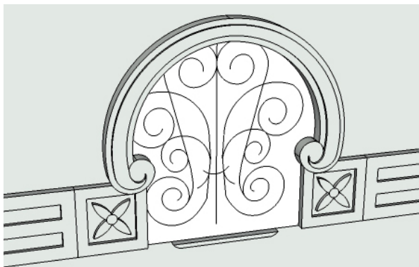
Fig. 97 | Fechamento dos vão do porão na fachada frontal. FONTE: Autora, 2017.
