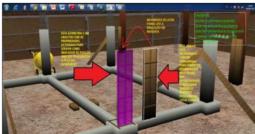
Figura 15 – Montagem de fôrma no canteiro de obra virtual
