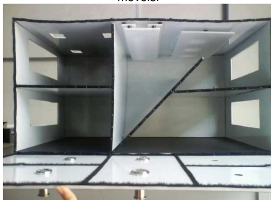
Figura 19 - Maquete de iluminação natural – interior, com destaque para as proteções zenitais e paredes móveis.
