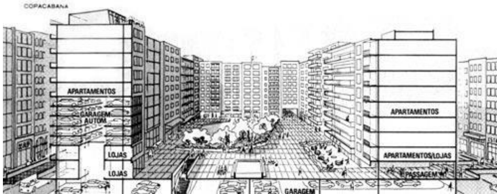
Figura 73: Desenho em corte do Plano Doxiadis, exemplificando a proposta dos níveis de circulação.
