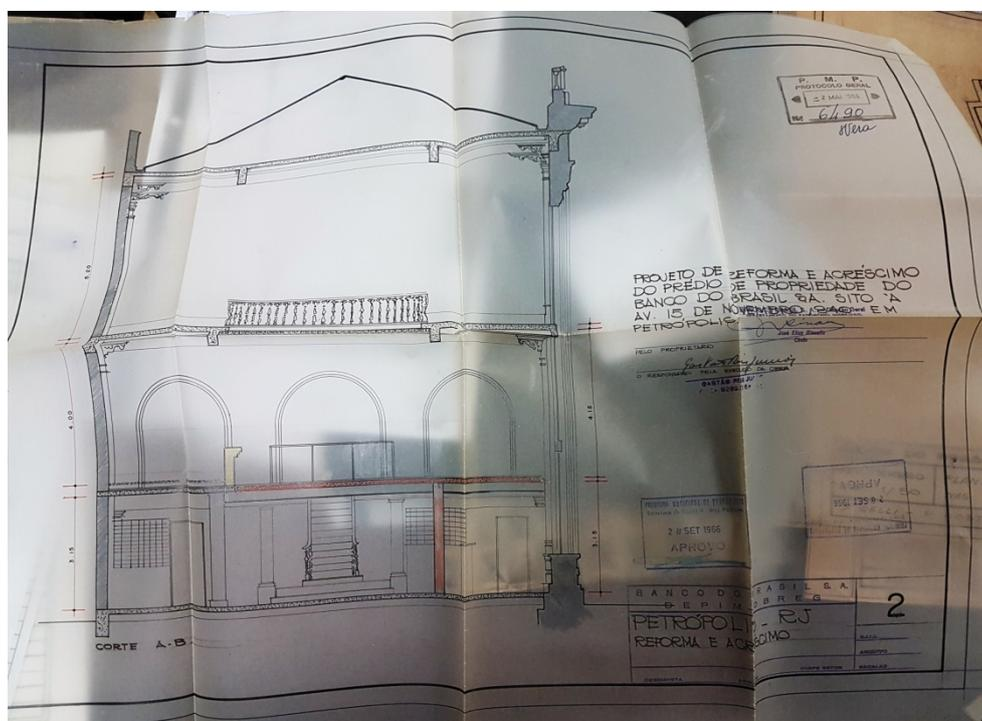
Figura 25 - Corte esquemático indicando a cronologia da construção da laje, em duas etapas e corte original, de 1966, com carimbo de aprovação da Prefeitura de Petrópolis
