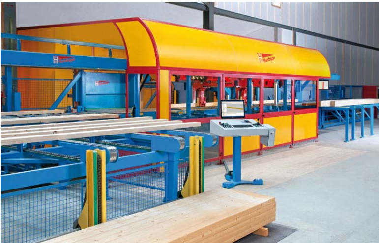
Imagem 48: Máquina K2 de 5 eixos para processamento e produção de encaixes de madeira. Fonte: Hundegger.
