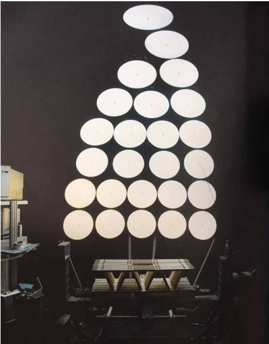
Imagem 78: Estudo com domo de luz para análise da transmissão de luz através da estrutura de multicamadas. Fonte: GRAMAZIO, 2014a.
