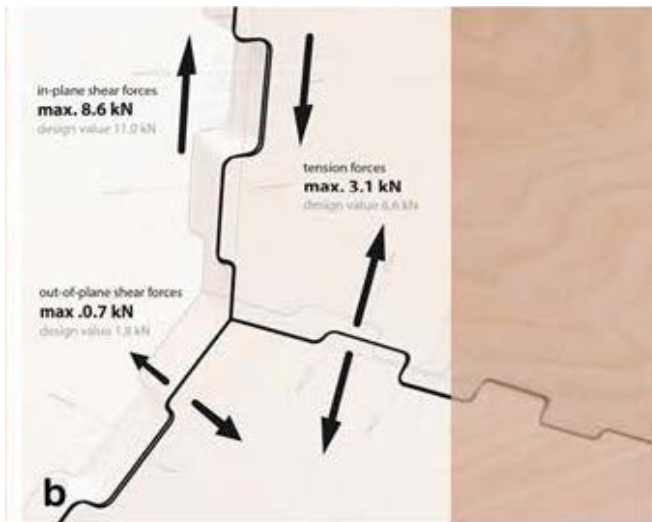
Imagem 89: Forças atuantes nas junções. Fonte: KRIEG et al., 2014.
