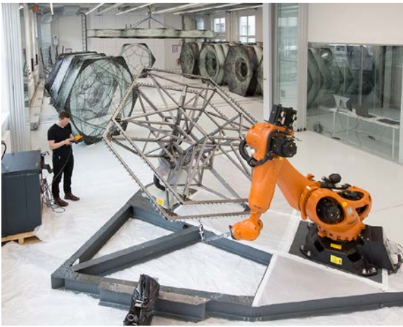
Imagem 108: Set-up de fabricação do Elytra Filament Pavilion. Fonte: ICD.
