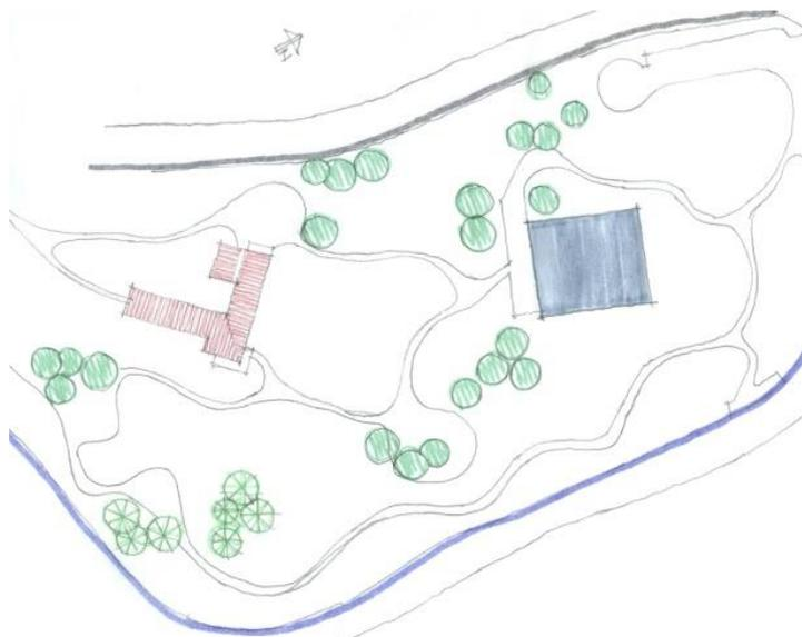
Figura 104: esquema de implantação com opção por um volume único para nova edificação incorporando o programa como um todo e resultando em contraste desfavorável com o bem tombado. Desenho do autor s/ escala, Agosto de 2018.
