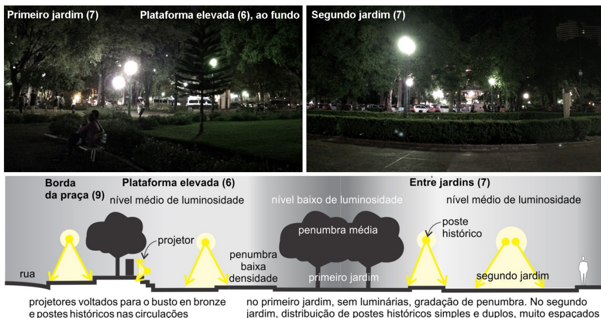
Fig. 88: A distribuição e os níveis de luminosidade nos trechos (6) e (7). | Fonte: Tatiana Ferreira, 2018.
