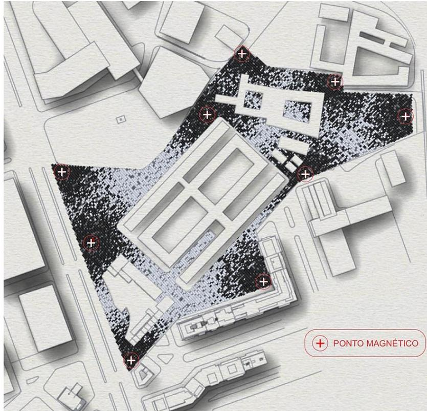
Figura 63: planta baixa, estudo de piso urbano degradê com desenho generativo entorno da quadra remanescente após desmorte do Morro do Castelo-RJ . Piso degradê com peças de 1 x 1m de granito branco, cinza claro, cinza escuro e preto. Composição desenvolvida com o *software rhinoceros + plugging grasshoper*. Fonte: elaborado pelo autor.
