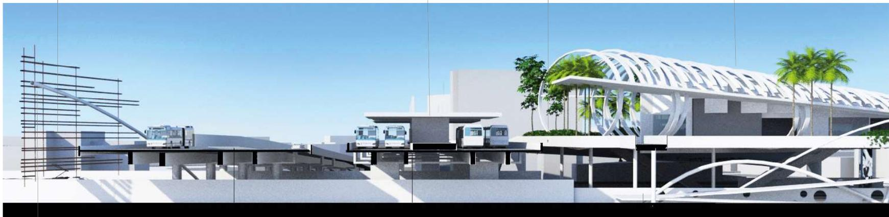
estrutura metálica tubular fixada ao viaduto para suporte de Brises em madeira
