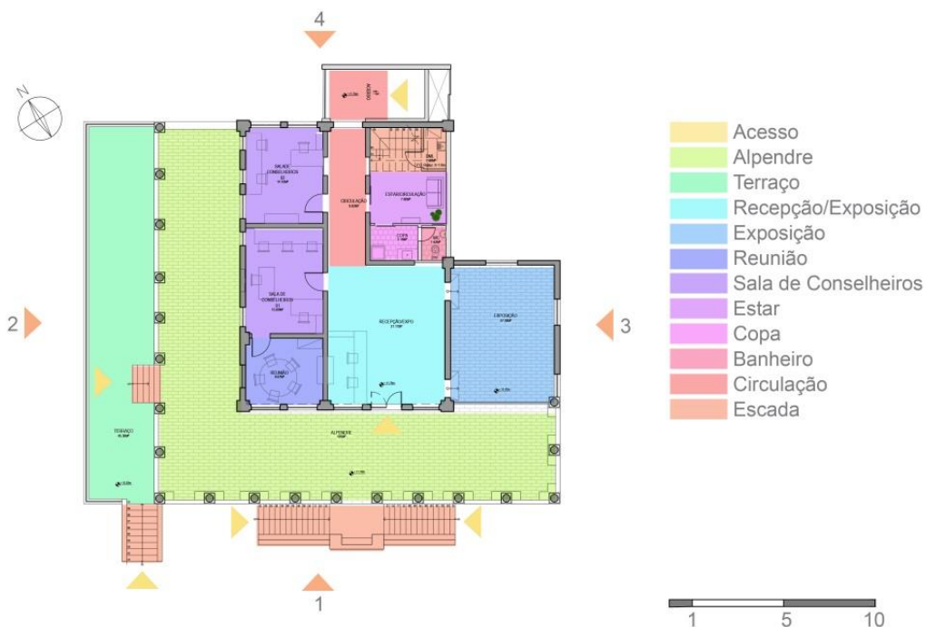
Figura 95 - Planta do primeiro pavimento da edificação Sede. Fonte: Desenho da autora, 2018.
