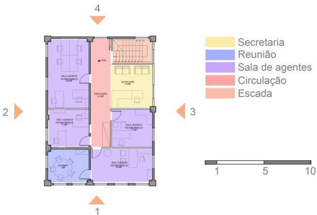
Figura 95 - Planta do primeiro pavimento da edificação Sede. Fonte: Desenho da autora, 2018.
