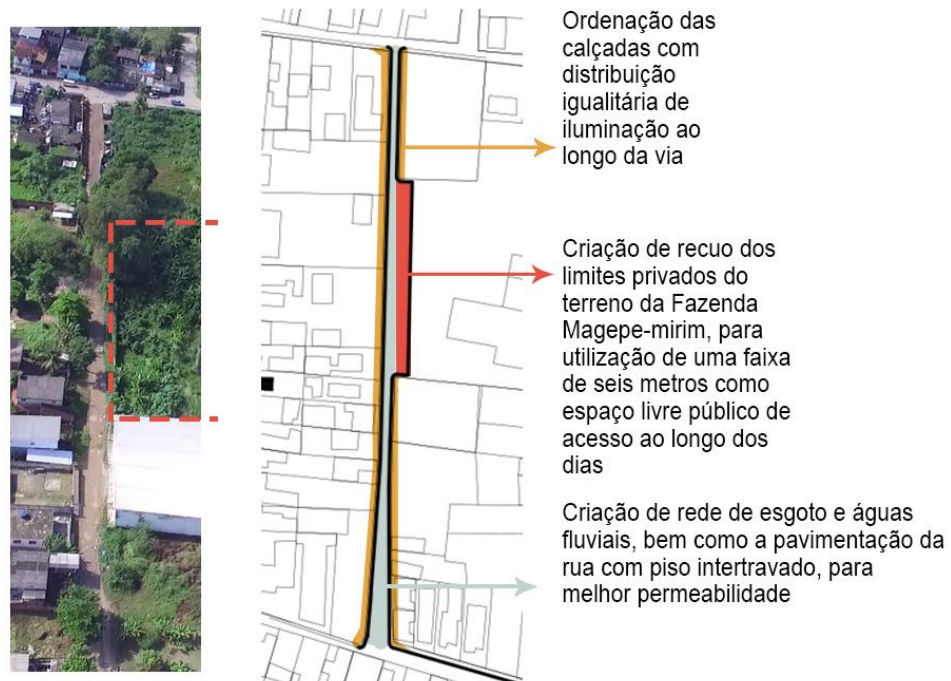
Figura 84 - Esquema proposto na Rua Artur Silva, prevendo a requalificação da mesma de maneira a convidar os próprios moradores a permanecerem no recuo criado para livre acesso público em parte do lote da edificação. Fonte: Fotografia e desenho da autora, 2017.
