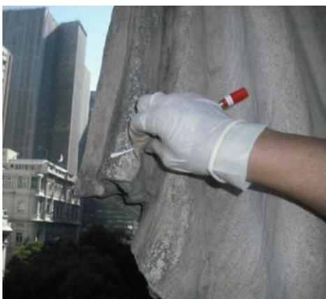
Figura 164 – Coleta de material da *Cariátide*, extremidade direita da fachada da Avenida Rio Branco.
