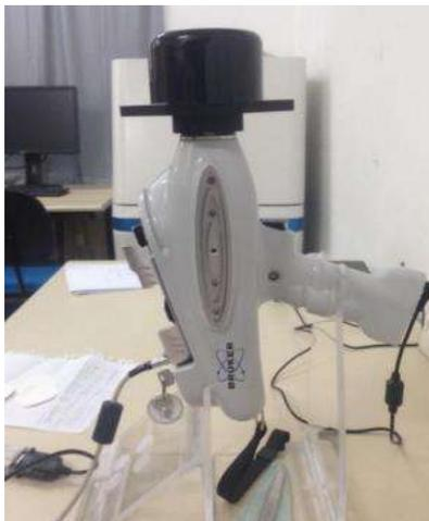
Figura 156 - Sistema de XRF utilizado nas análises.
