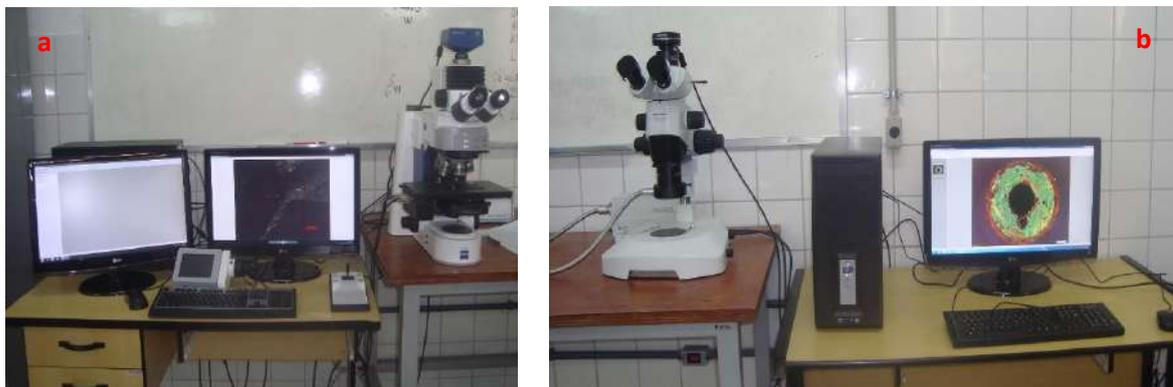
Figura 154 - Microscópio óptico Carl Zeiss(a); microscópio estéreo Olympus(b).
