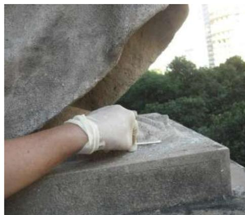
Figura 165 – Coleta de material da *Cariátide*, extremidade esquerda da fachada da Avenida Rio Branco.
