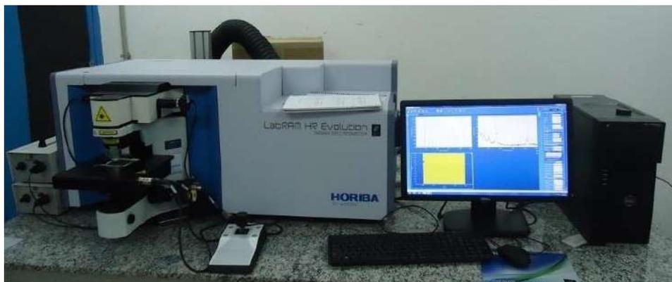
Figura 157 - Espectrômetro Raman LabRAMEvolution da HORIBA.
