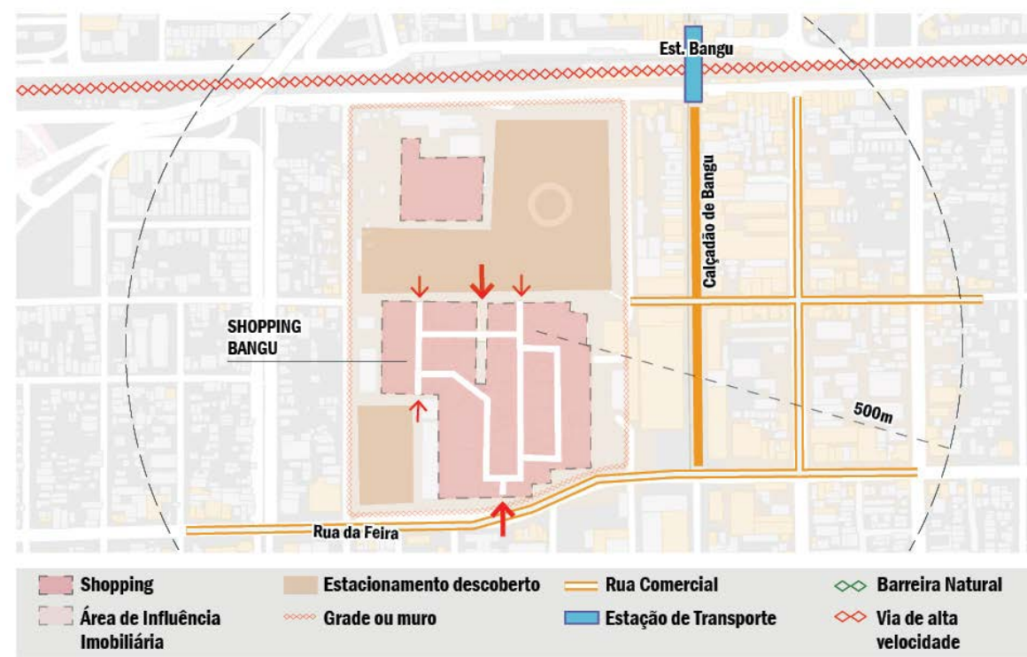
Figura 3.45. Shopping Bangu: Acessos e Barreiras. Fonte: Elaborado pela autora com base no GM, 2018
