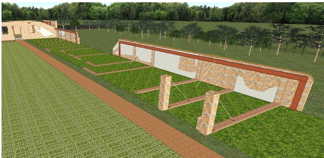
*Figura 138 - Alvenaria da Senzala: contraventamento em cabos de aço.
