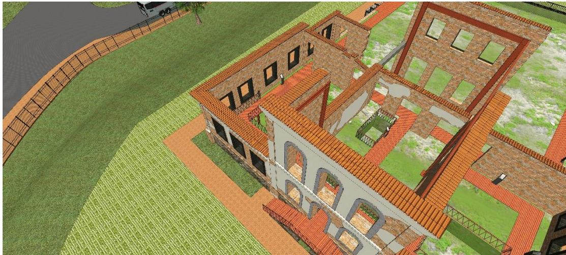
*Figura 139 - Proteção no topo das alvenarias com telha capa e bica.
