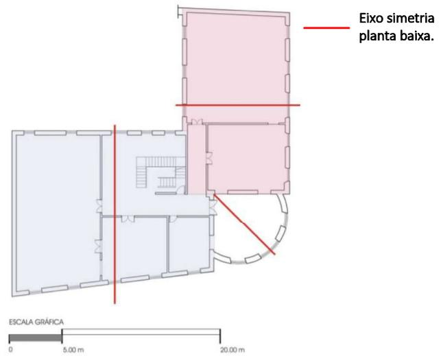
Figura 13. Eixos de simetria 2º pavimento.
