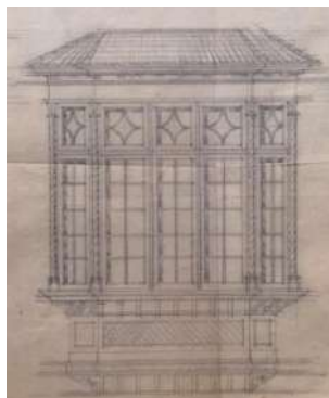
Figuras 178 a 180 – Ricardo Severo - Janela avarandada com muxarabi em São Paulo; Archimedes Memória e Francisque Cuchet - Detalhe do bow-window das fachadas do Palácio das Grandes Indústrias, o mesmo empregado no projeto de Heitor de Mello para o Grupo Escolar D. Pedro II, em Petrópolis. Fontes: Severo(1916); Acervo NPD-FAU/UFRJ; Foto do autor, 2022.
