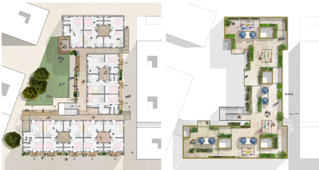
Figura 80: Plantas baixas do térreo e da cobertura do projeto das novas construções para a Favela de Sanjaynagar – circulações de corredores e escadas abertos
