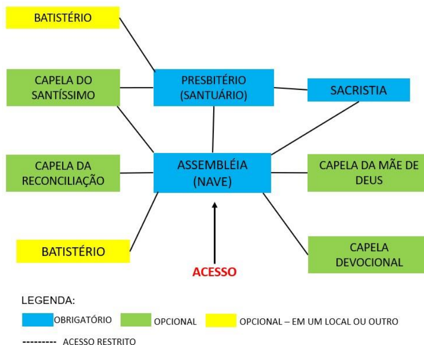
Figura 32: Fluxograma de uma igreja após o Concílio Vaticano II. Desenvolvido com base em documentos conciliares, pós conciliares, no Missal Romano e de ritos específicos.
