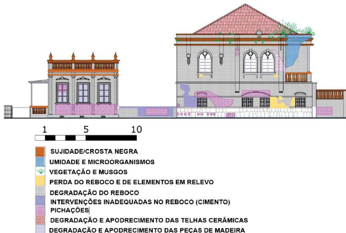
Figura 70. Mapeamento de danos das fachadas frontais. Fonte: Autora (2022).
