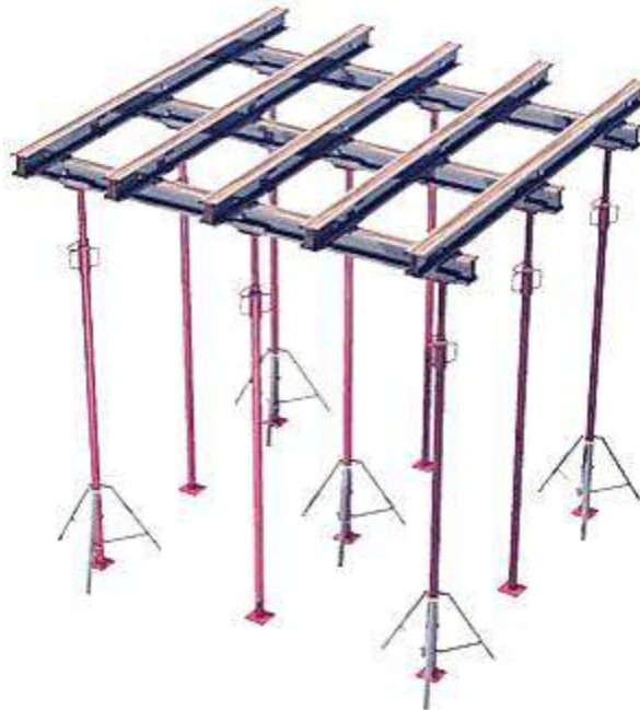
Figura 104 - Esquema de escoragem com barra roscada. Fonte: AM Andaimos Modulares. Disponível em < https://www.andaimosmodular.com.br/produtos/escoramentos/escoras-pontuais >. Acesso em 22 out. 2021.
