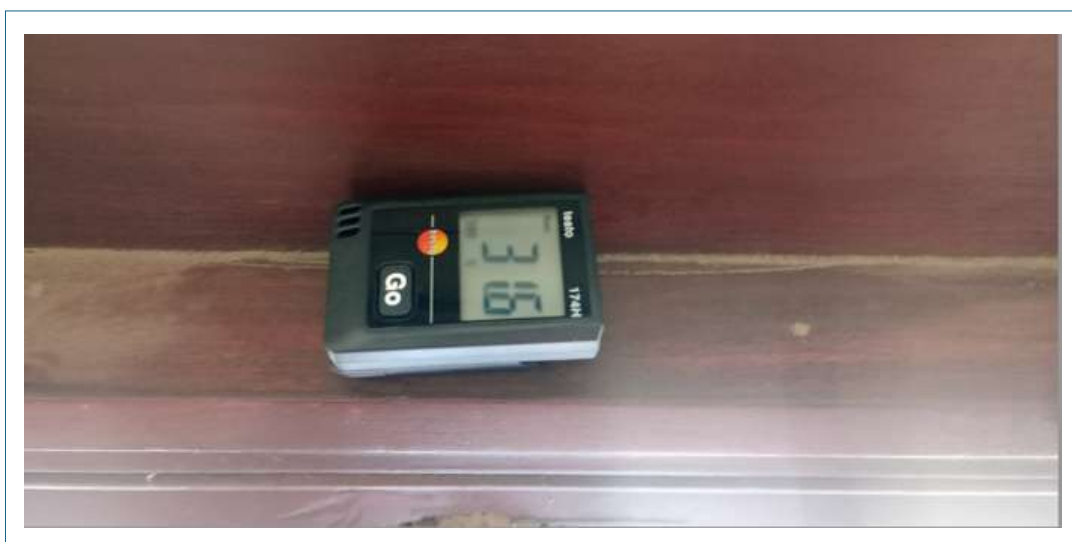
Figura 92: Higrômetro instalado na esquadria do Salão Raymundo Moniz.
