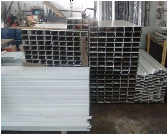
Figura 9: Perfis cortados e usinados recebidos para montagem na fábrica.
