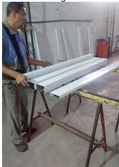
Figura 10: Acabamento dos cortes dos perfis antes da montagem.
