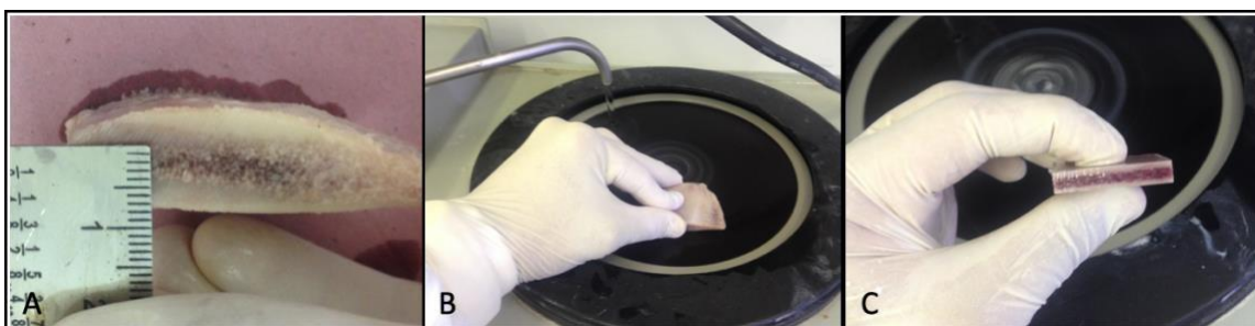
Figura 1. Preparo do corpo de prova. A) Verificação da altura do osso esponjoso necessário. B) Desgaste das corticais através de lixa d'água número 1000 em máquina Politriz para obtenção de 1 mm cada lado. C) Aspecto final do corpo de prova com as superfícies superior e inferior regularizadas.
