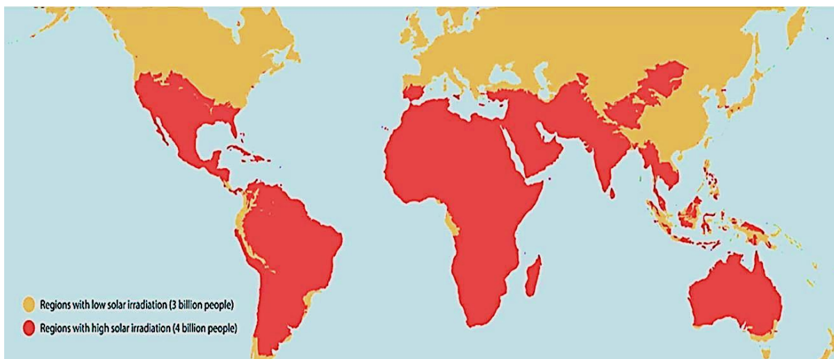
Figura 8: Regiões do mundo com baixa irradiação solar (áreas bege) (soma diária <4,4 \text{ kWh/m}^2 ), enquanto áreas vermelhas representam áreas com radiação solar relevante (soma diária \geq 4,4 \text{ kWh/m}^2 ). O número de pessoas que vivem dentro da área bege (áreas mal irradiadas) foi estimado em cerca de 3 bilhões de pessoas usando o software Population Explore TM . Considerando que o norte dos EUA, o Canadá e a Europa contêm amplo acesso à água potável, isso significa que quase metade desse contingente, ou seja, ~ 1,5 bilhão de pessoas, se beneficiaria de um processo como o AM/SODIS em todo o mundo (CARDOSO-RURR; DE PAIVA; PAULINO-LIMA; DE ALENCAR et al. , 2019).
