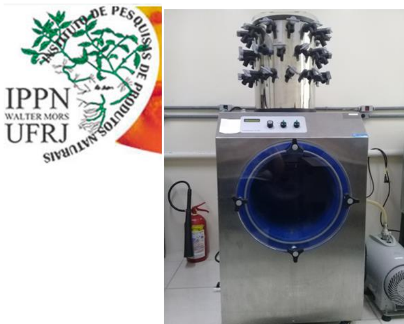
Figura 15 - Fotografia do liofilizador K120 (Instituto de Pesquisas de Produtos Naturais Walter Mors/UFRJ).
