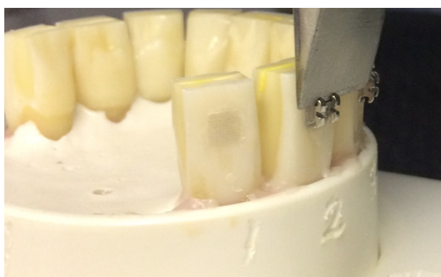
Figura 5 Fotografia mostrando a adaptação do cinzel entre a base e as aletas incisais do braquete para teste de resistência ao cisalhamento.
