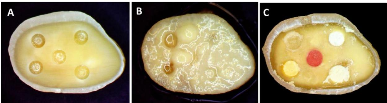
**Figura 5: Amostra 8. A) Amostra inicial com as cavidades preparadas. B) Amostra com biofilme formado. C) Amostra com as cavidades preenchidas pelos cimentos.**
