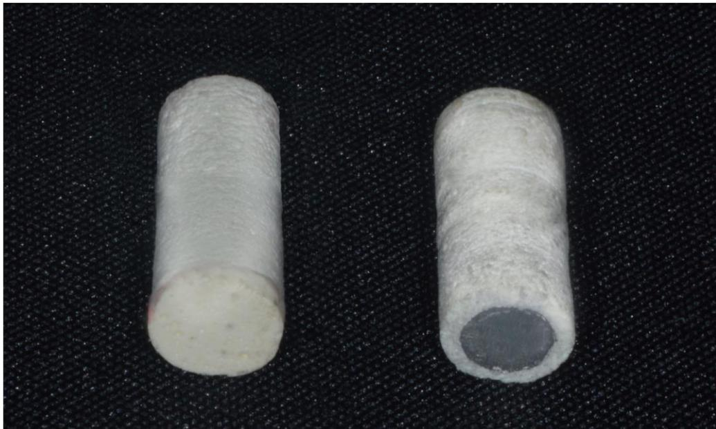
Figura 3: Corpo de prova padrão (esquerda) e corpo de prova metálico (direita)
