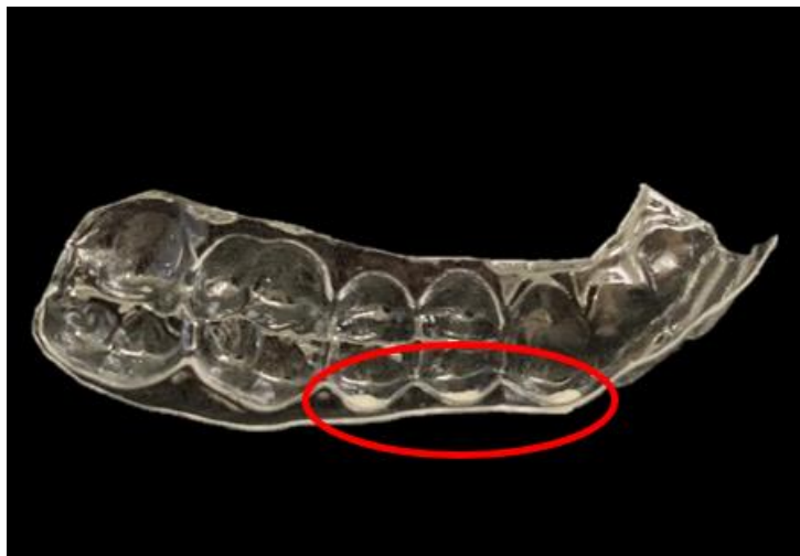
Figura 8 Elipse indicando região dos nichos com excesso de resina.
