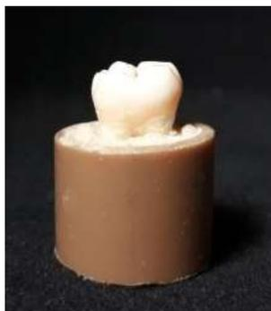
Figura 1: Dente fixado ao tubo de PVC com resina acrílica autopolimerizável.
