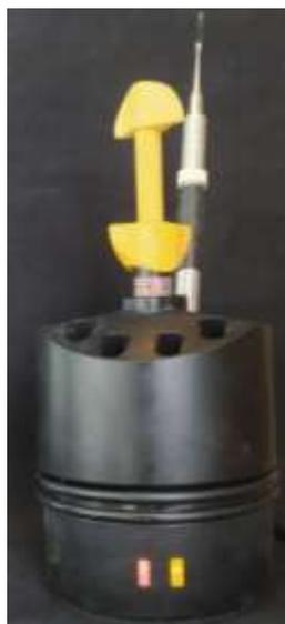
Figura 8: Dispositivo de aquecimento (Calset) aquecendo resina composta e a espátula para resina.
