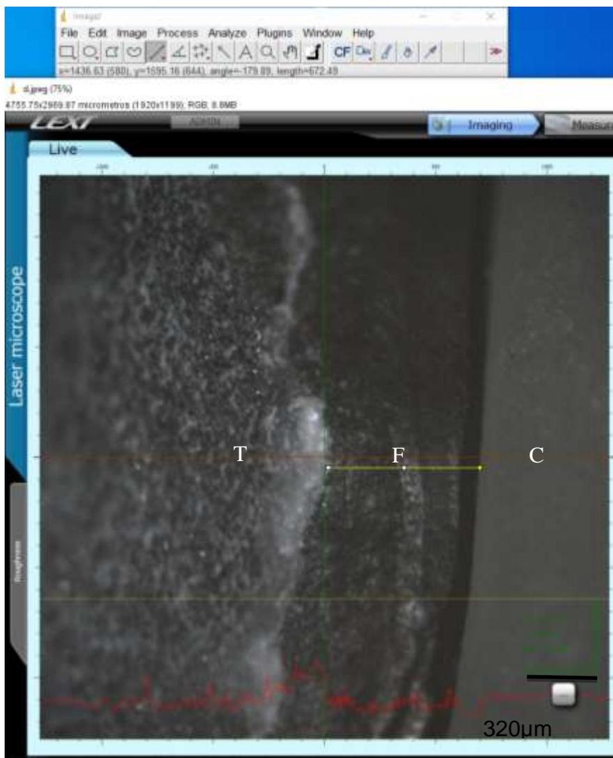
Figura 12: Fotomicrografia sobre a análise da adaptação marginal, representando o espaço entre margem externa da coroa até a linha de preparação oposta (linha amarela) .Legenda: C= Coroa cerâmica; F= Fenda; T=Término da réplica.
