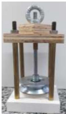
Figura 10: Dispositivo utilizado para padronização de pressão durante o assentamento da peça protética
