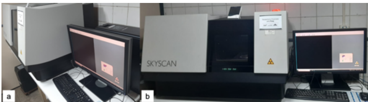
Figura 4. A) Vista lateral e B) frontal do microtomógrafo SyScan modelo 1173 conectado ao computador da marca Dell utilizado para realizar os escaneamentos antes e depois da instrumentação do espécime.
