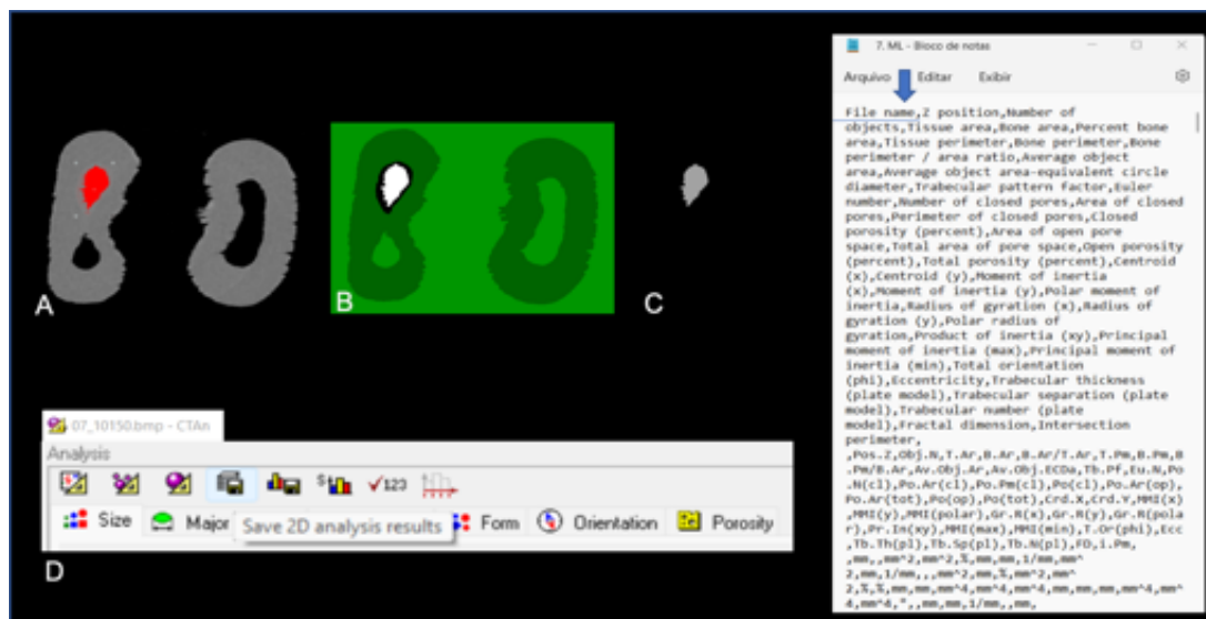
Figura 8. A) seleção da região de interesse (ROI) em vermelho. B) ROI preenchido digitalmente (branco). C) Obtenção da imagem real do canal após subtração. D) Arquivos salvos em resultados de análises 2D e obtenção dos dados quantitativos em formato Txt iniciados na linha “File name”.
