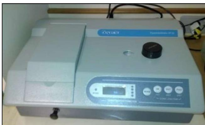
**Figura 6** – Espectrofotômetro.
